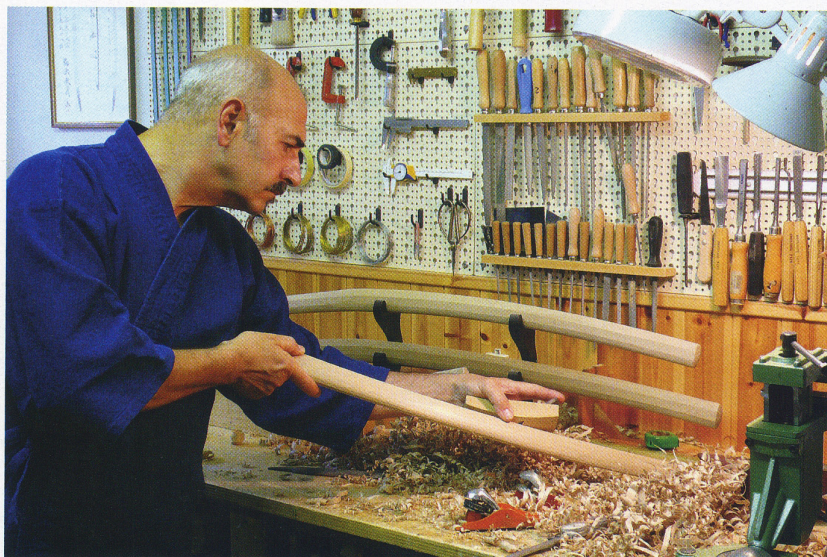
→ I due semigusci sono stati già incollati. Tempo di definire a pialla il profilo esterno.
